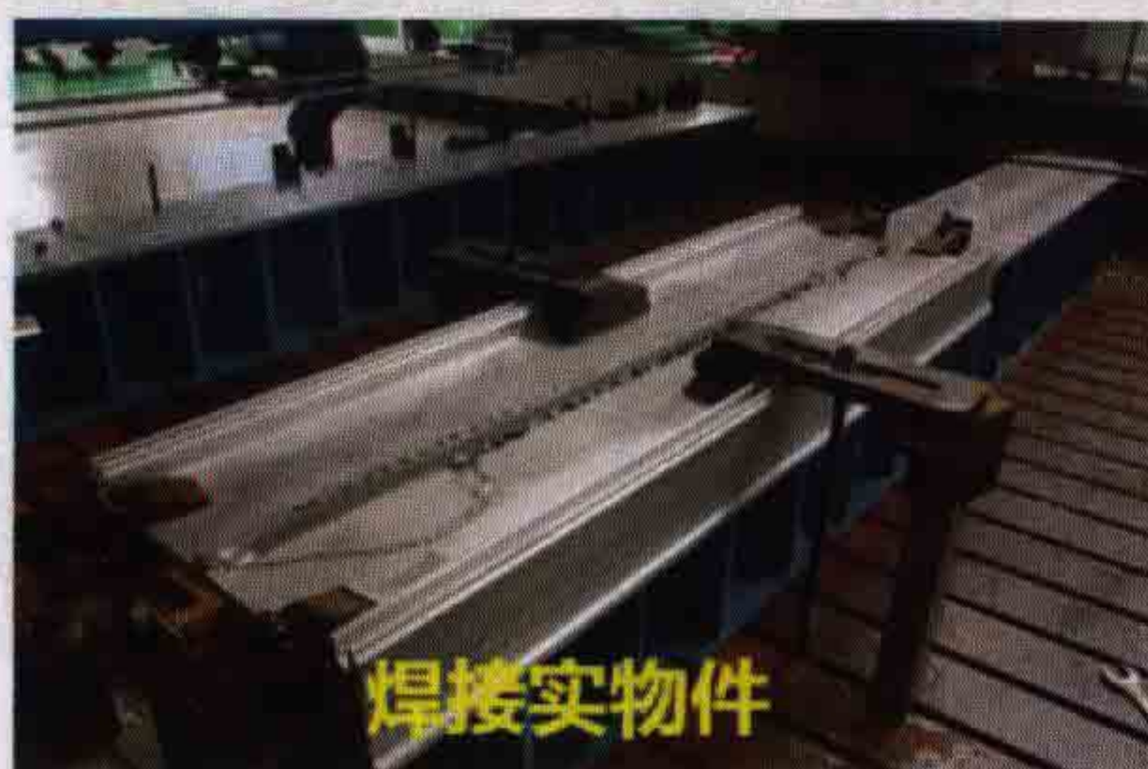
中车集团长客公司80 mm厚铝合金车钩座板焊接
