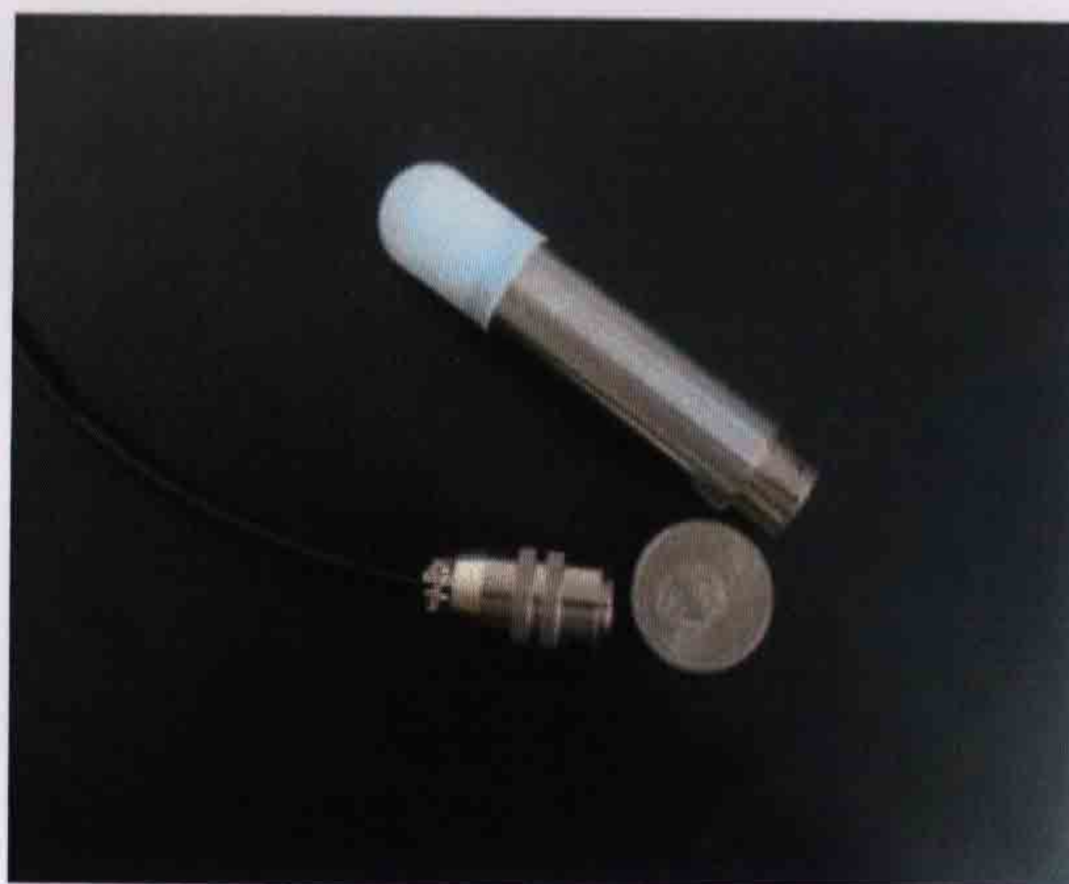
批量化制造的传感器芯片（4 寸晶圆） 批量化制造的谐振式压力传感器
