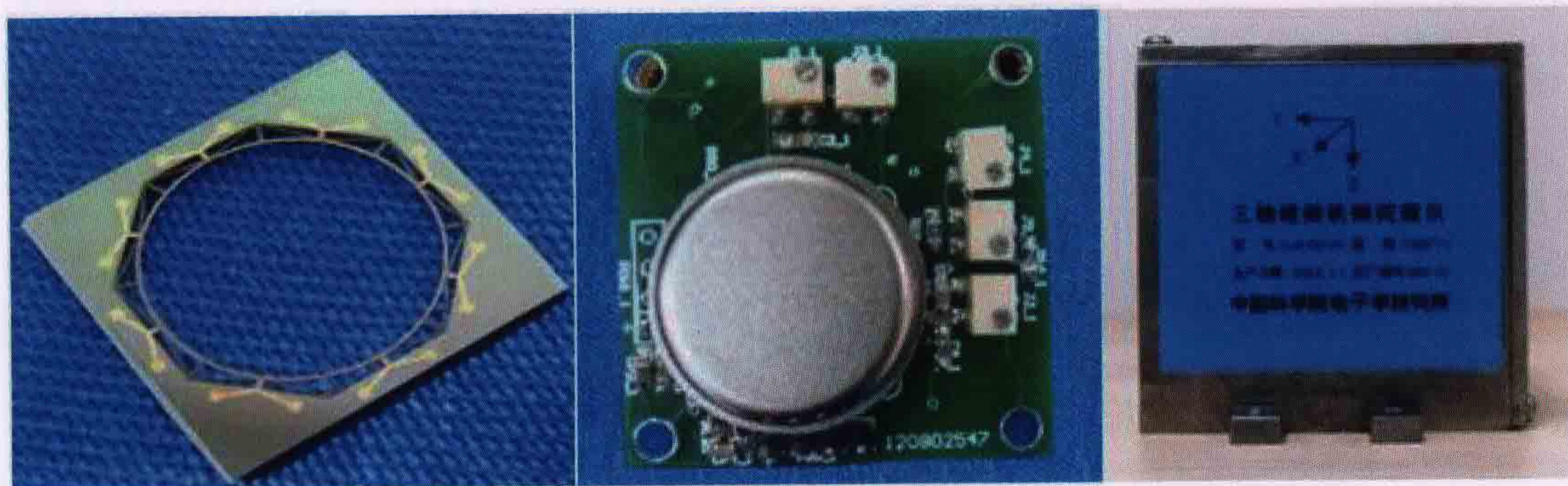
电磁式振动环微机械陀螺仪照片
