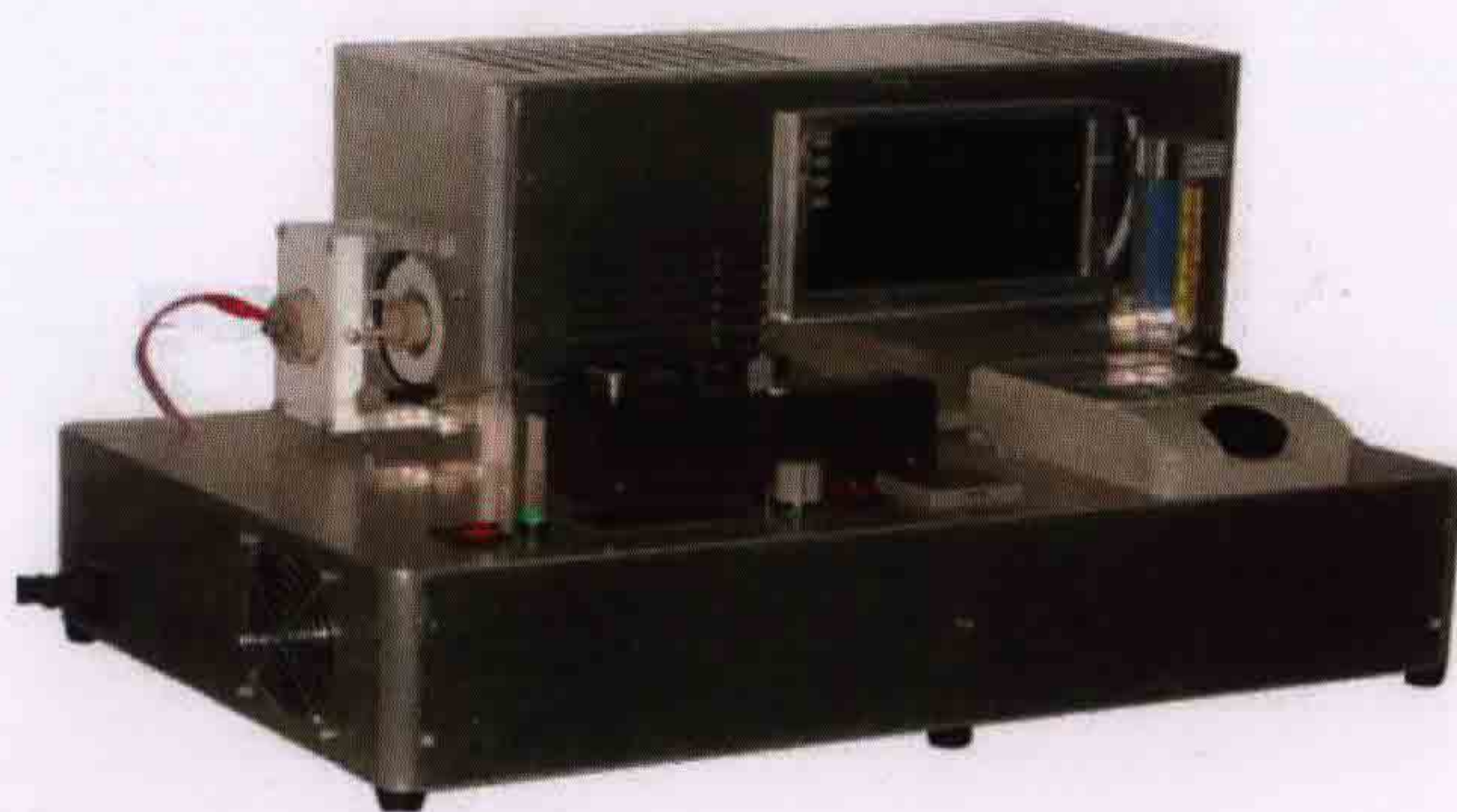
电喷雾离化离子迁移率谱仪
