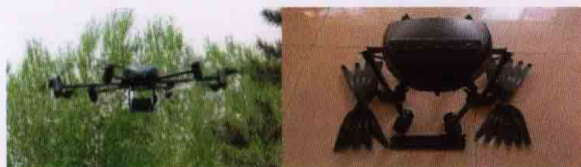
多旋翼空中巡查平台(空中飞行状态与收起状态)
